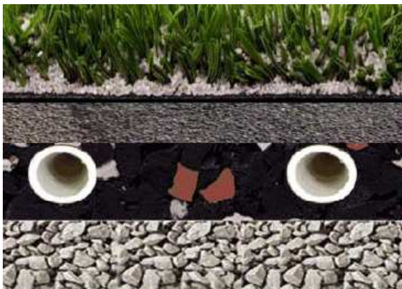
Kunstrasenkollektoren: In Dämpfungsschicht des Kunstrasenfelds integriertes Bohrungssystem zur Wärmege- winnung. Quelle: Planungsbüro Wegmüller, Klosters.
