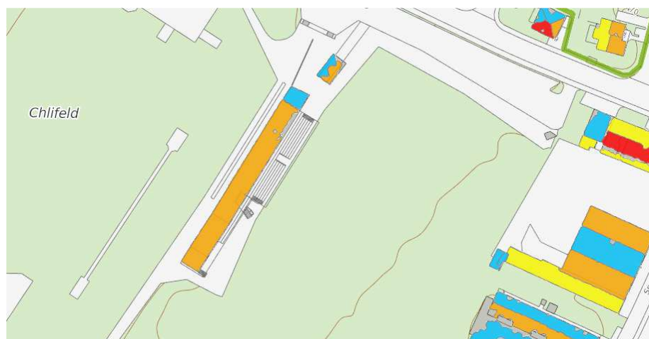
Tribünengebäude Kleinfeld: Gemäss Solarpotenzialkataster des Kantons Luzern eignet sich die heutige Dachflä- che gut zur Nutzung von Sonnenenergie. Quelle: www.solar.lu.ch .
