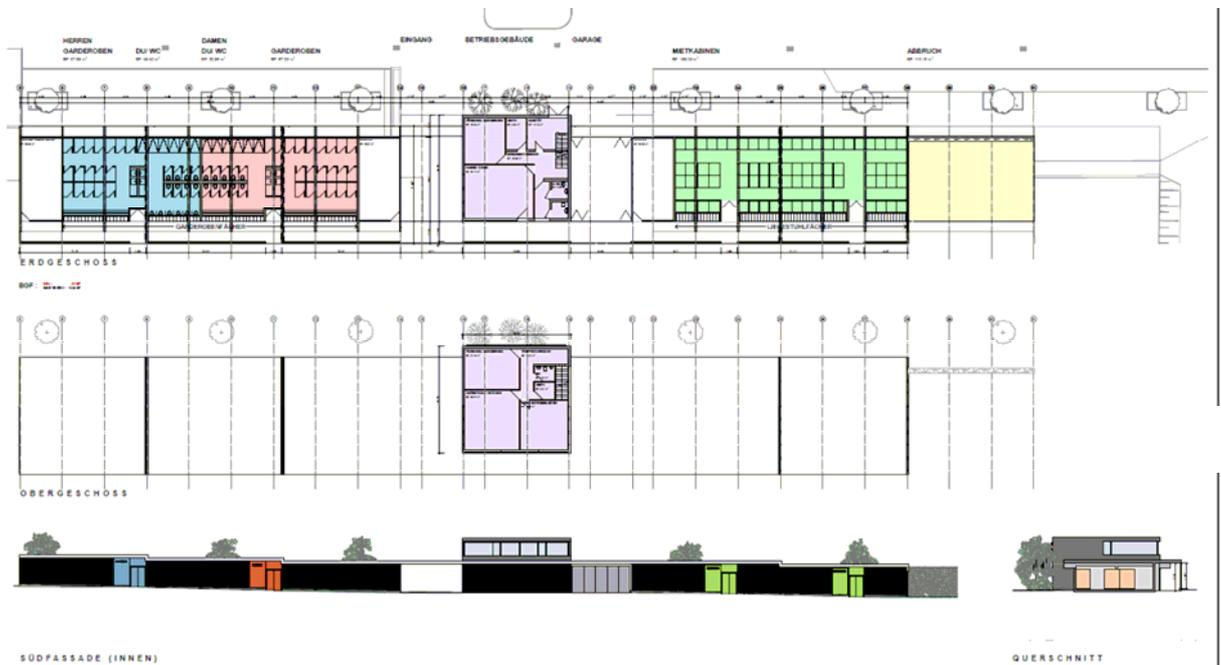
**Abbildung 20:** Variante mit Ostflügel (Erhalt Mietkabinen).
