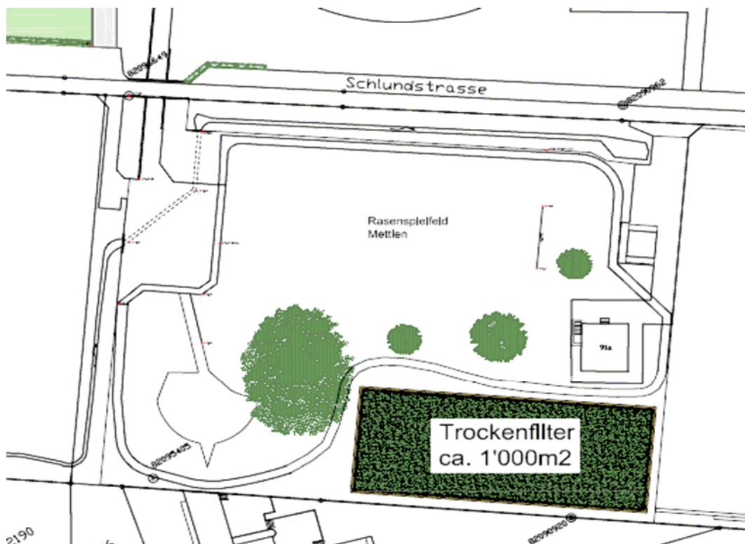
Abbildung 7: Konzept Trockenfilteranlage ("Neptunfilter") im Perimeter Spielplatz-Mettlen
